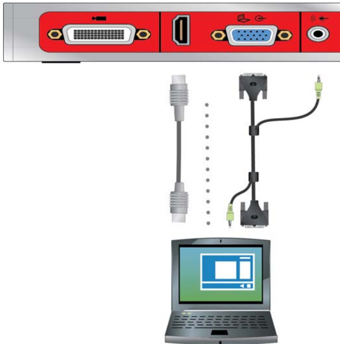
圖 3: RealPresence Group 310 和 500 系統接線方式
